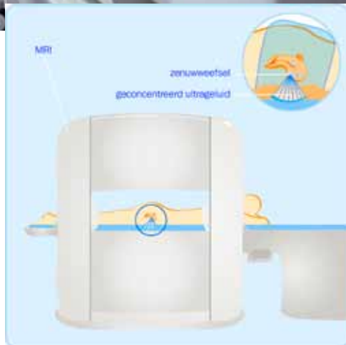
Een MR-HIFU systeem. De HIFU-transducer is ingebed in een MRI-tafel. Tijdens de behandeling worden real time MRI-beelden gemaakt om de behandeling te volgen (zie inzet).
